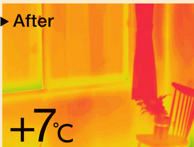
今ある窓+内窓(インプラス)／単板ガラス3mm+Low-E複層ガラス
